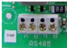
Klemmleiste – auroPOWER VPI/1-Modelle
